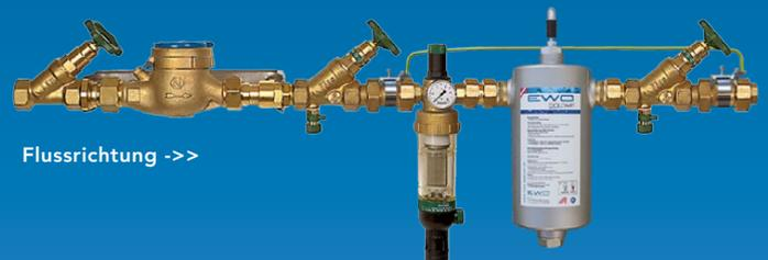
Je nach Wasserverbrauch und Wasserqualität hat die Magnesiumanode eine Lebensdauer von 2-3 Jahren. Ein Tausch der Anode ist notwendig, wenn sich die Farbkapsel (Verbrauchsanzeige) rot verfärbt. Die verwendete Magnesiumanode besteht aus 99,7% reinem Magnesium und entspricht der Europäischen Norm: 12438 - für Trinkwasser zugelassen.
