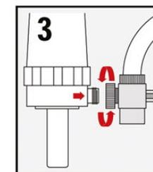
Umschaltventil mittels Überwurfmutter ans Filtergehäuse schrauben - fertig!
